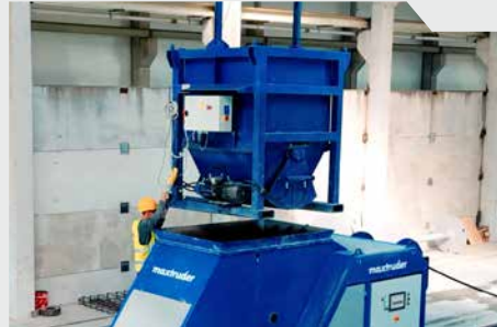
Benne à béton
