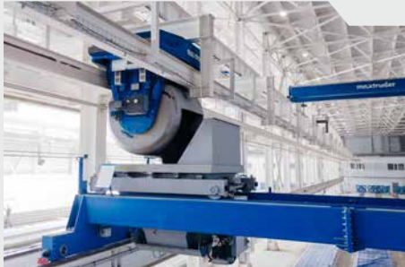
Distributeur de béton
