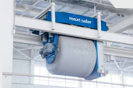
Système de transport du béton
