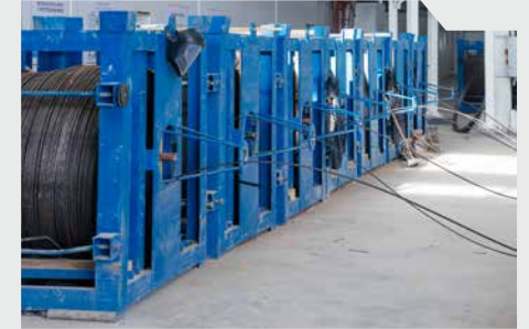
Stocker et dérouler fils de précontrainte
